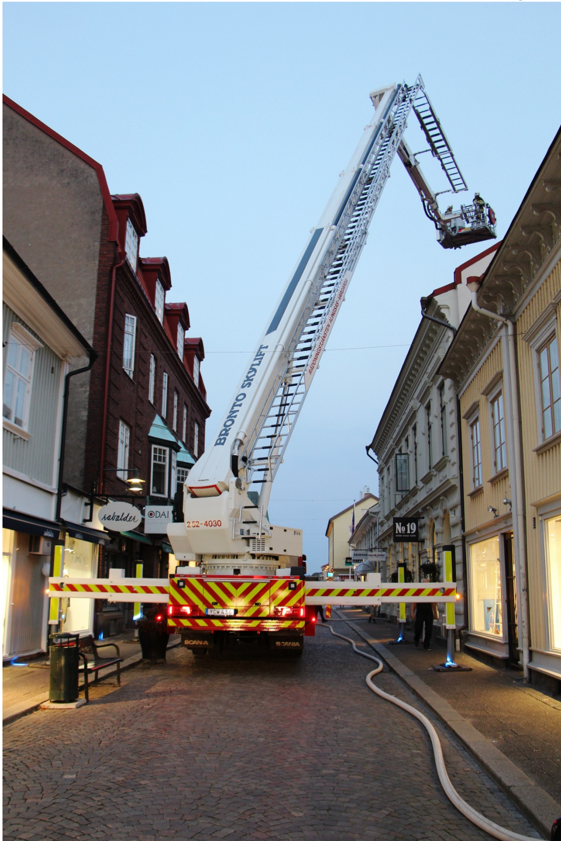
Lamporna med blått sken är bra att ha för att se att bredden är tillräcklig vid utfällning av stödbenen.
